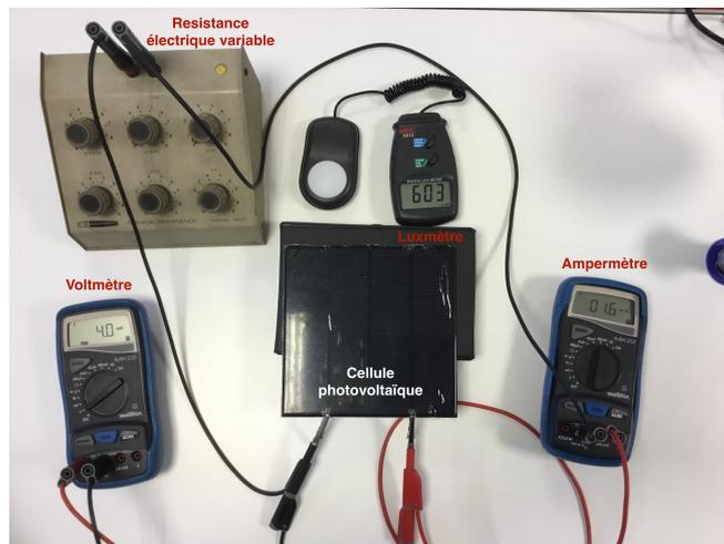
Montage pour la caractérisation de la cellule photovoltaïque.
