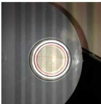
**Information sur la section** Il est aussi important de remarquer que le dispositif, pourvu d'un diamètre indicatif de 32 mm à son extrémité, est également pourvu d'un petit décrochement qui est visible en rouge sur l'image ci-joint. Ce décrochement a été mesuré et c'est la section minorée qui est utilisée dans l'application numérique suivante.
