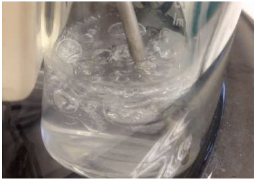
Observation du point triple sous la cloche à vide
